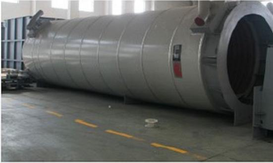
导热油辐射炉及对流炉在待运输状态
