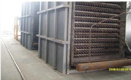
生产中的对流导热油炉
